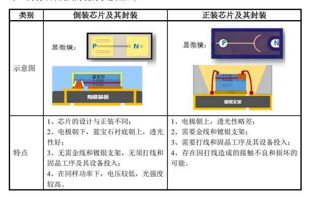
倒装芯片及其封装过程可节省金线、导线架等材料,省去了打线、固晶等生产环节,成本将显著降低,因此使用倒装芯片及其封装的 LED 应用产品也将取得一定的成本优势。
